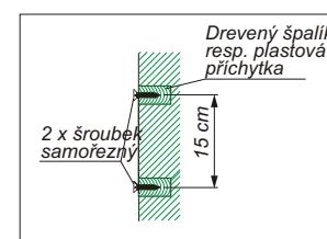
Na stěnu ve výšce asi 1,5 m nad podlahou namontujte šroubky v předepsané vzdálenosti podle obrázku tak, aby telefon po zavěšení přiléhal ke stěně.
