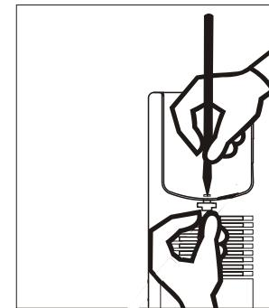
Pomocí ostrého předmětu (např. malým šroubováčkem) stlačte přídržovací kontakt přes otvor, čímž uvolníte záhytný držák.
