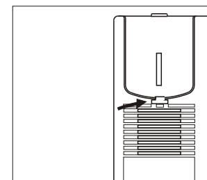
Pootočte záhytný držák o 180° a znova ho vložte tak, jak je to uvedené na obrázku.
