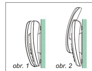
Nasadte telefon na šroubky do upevnovacích otvorů na spodním krytu přístroje (viz obr. na str. 2) a zasuňte ho směrem dolů (obr. 1).
